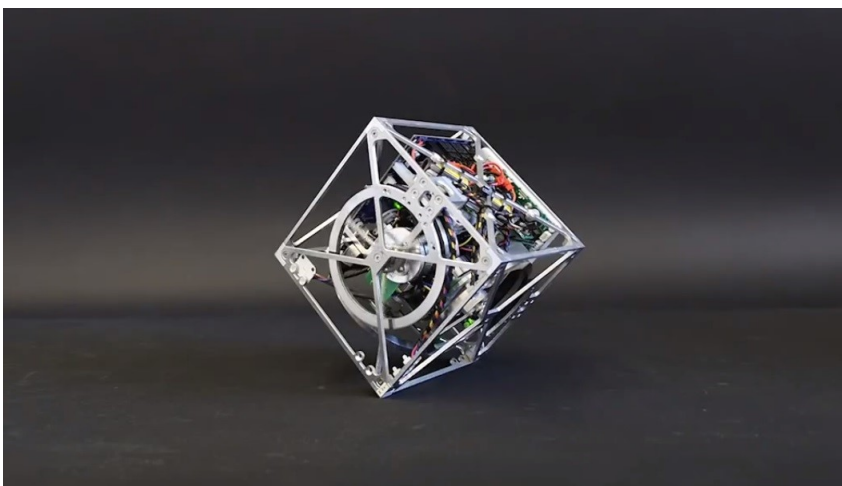
Figur 2.4 Exempel på hur Cubli kan balansera ett system (Cubli 2018).
