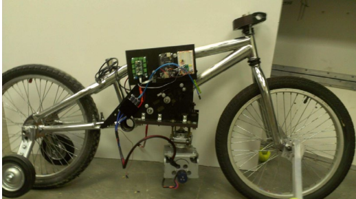
Figur 2.3 Cykeln som användes vid forskning på Stanford University. Stödhjulen är endast där för att rädda systemet när det misslyckas med att balansera (Yetkin 2014).
