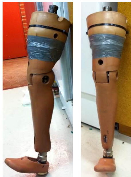
Figur 4. Över- och underben på BioRID 50F_P2 (övre delen av låret nerskalade delar från BioRID 50M; nedre delen av låret samt underbenet från Hybrid III 5F).
