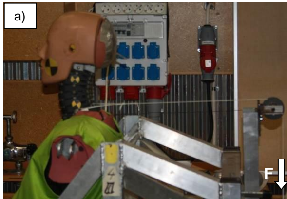
Figur 14. Provuppsättning – statiska prov a) Dragprov b) Momentprov. Vit pil symboliserar applicerad kraft.
