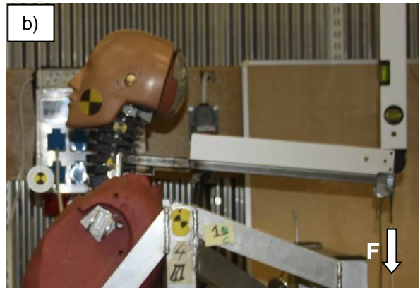
Figur 14. Provuppsättning – statiska prov a) Dragprov b) Momentprov. Vit pil symboliserar applicerad kraft.
