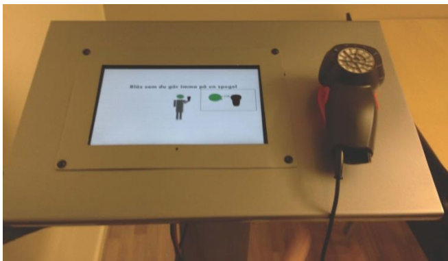
Figur 3. En första modulprototyp med handhållen alkomätare
