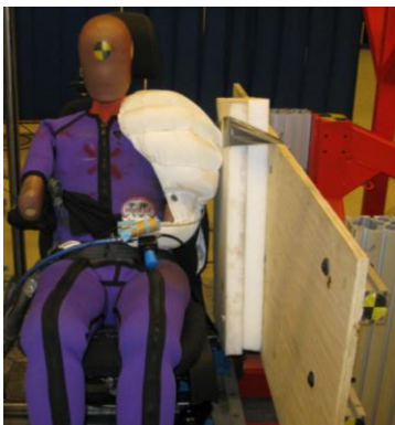
Figure 4. WorldSID med krockkuddeskydd runt axeln
