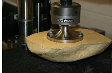
Figur 52. Provmetod baserad på uppmätningar av underlagets kraft/deformations-egenskaper med hjälp av en servohydraulisk provningsmaskin (Instron 8872; Glinka m.fl. 2013). Rigida modeller av a) huvud, b) höft och c) fot användes för att belasta underlaget (Glinka m.fl. 2013). Bilderna har erhållits via personlig korrespondens med Andrew Laing. Obs: Bilden av huvudmodellen visar ett prov med islag mot örat och inte bakhuvudet.
