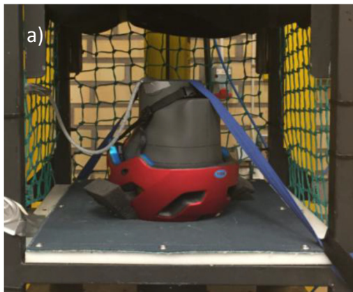
Figur 44. Hjälmprovning enligt a) Lagkravsprov (SS-EN1078) b) Cykelolycka 3 (bilder från Stigson 2015 ).
