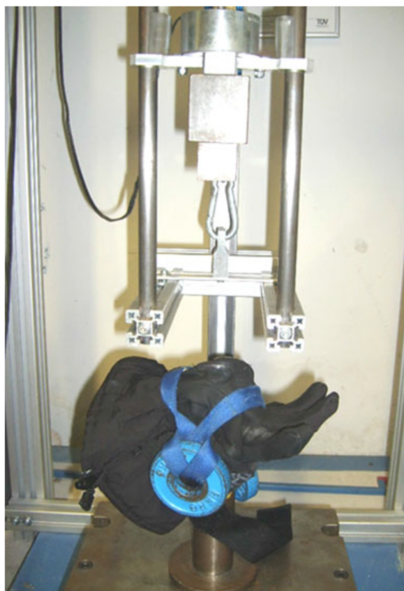
Figur 30. Schematisk beskrivning av den föreslagna testmetodsstandarden i a) fallprov och b) utböjningsprov, för utprovning av handledsskydd. Med tillåtelse från Kai-Uwe Schmitt, AGU Zürich, att använda bilderna från Michel m.fl. (2013).
