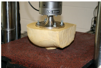
Figur 52. Provmetod baserad på uppmätningar av underlagets kraft/deformations-egenskaper med hjälp av en servohydraulisk provningsmaskin (Instron 8872; Glinka m.fl. 2013). Rigida modeller av a) huvud, b) höft och c) fot användes för att belasta underlaget (Glinka m.fl. 2013). Bilderna har erhållits via personlig korrespondens med Andrew Laing. Obs: Bilden av huvudmodellen visar ett prov med islag mot örat och inte bakhuvudet.
