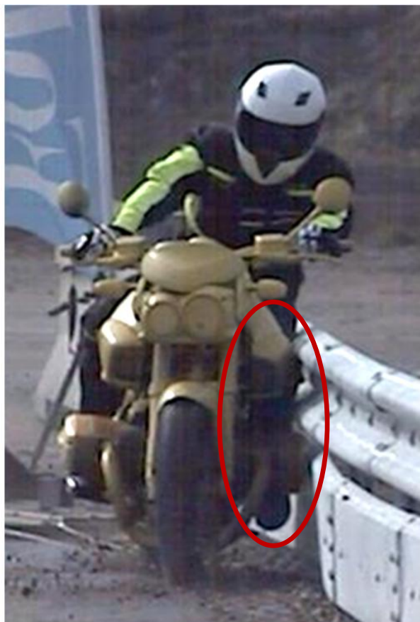
Figur 11: första träffen i räcknet i test 1 och test 3.
