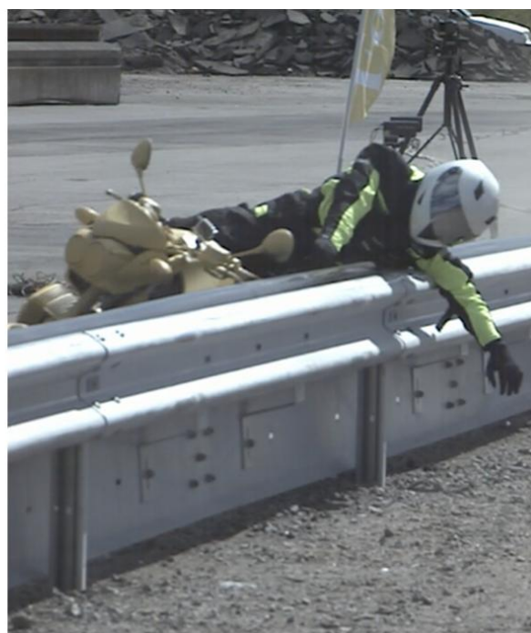
Figur 12: dockan glider på ovansidan av räcknet i test 3 och test 4.
