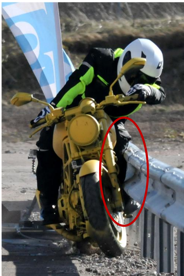
Figur 11: första träffen i räcknet i test 1 och test 3.
