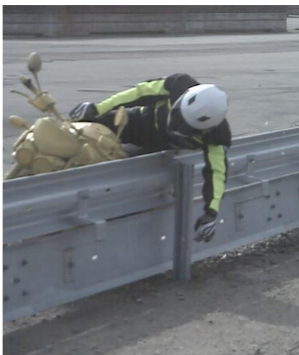
Figur 12: dockan glider på ovansidan av räcknet i test 3 och test 4.
