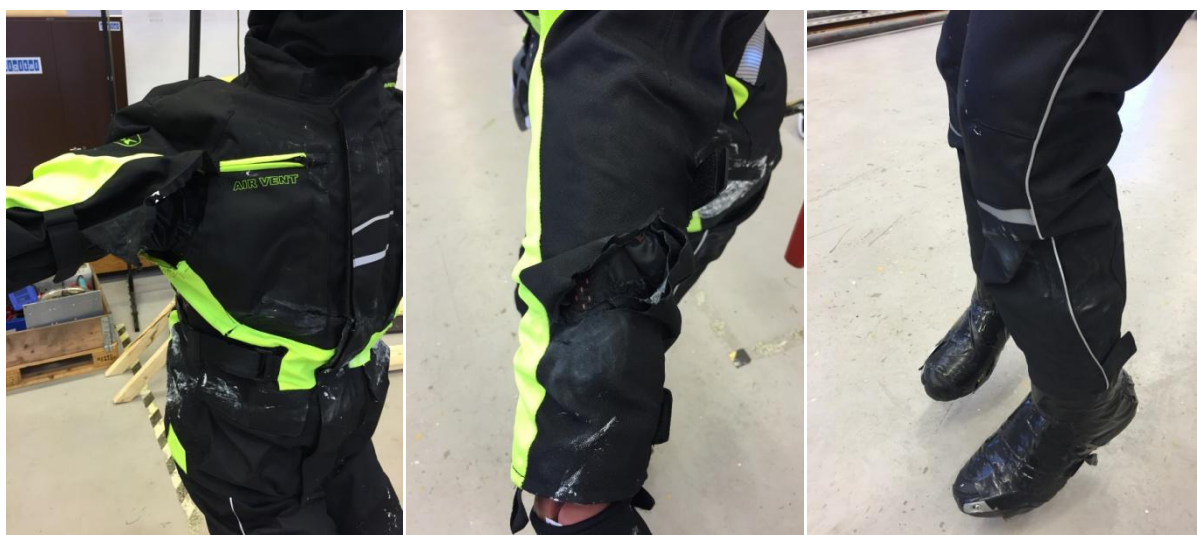
Figur 8: förlopp och skador i test 2.
