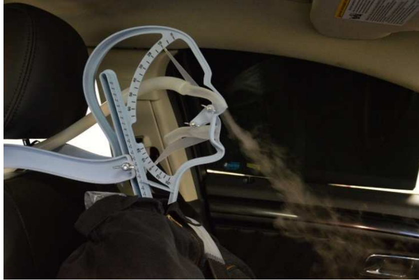
Fig 4. Flödesexperiment i fordonskupé med simulerad utandning från ett artificiellt ansikte.
