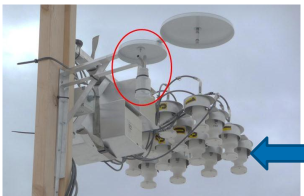
Figur 1.1 Foto som visar de 8 provtagningshuvudena för den aktiva mätningen samt fluxprovtagaren (inringad).
